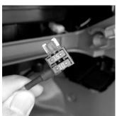
アクセサリー電源(エンジン始動により DC12V+が流れる電源)を確保します。ダッシュボード下の中央にヒューズボックスが
