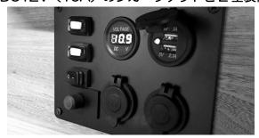
一般的に1台の車に10Aのシガーソケット出力を2か所設置する事は難しいとされております。本キットではエンジン始動時であれば運転席側キャビネットより2基のシガーソケット(10A×2)が使用できます。
