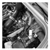
助手席シートを上げてエンジンルームを開き、バッテリーの「+」と「-」それぞれにメインケーブルを接続します。(赤+とーを 間違えないように注意してください)メインケーブルはサービスホールを通した後にギボシ連結します。アクセサリー電源線と共 に運転席側キャビネットの位置まで配置して行きますが、内張りやシート金具等に挟んで破損させないようにご注意ください。各 ケーブルの「+」とボディアース等を含めた「-」が触れた場合に短絡(ショート)して大変危険です。車両の電子回路等が破損 する恐れもございますので配線作業には充分な注意をお願いします。(自信が無い場合には自動車整備工場等にご依頼ください。)
