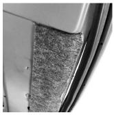
ハイゼットカーゴに関しましてはリアシートベルト部の内張りも外してください。次にリアゲートのゴムモールを浮かせた状態で運転席側、助手席側ともに付属のフェルトシートを貼ります。(1mm 厚の両面テープ使用)後方ギリギリに沿って高さはボディ鉄板のプレスラインに合わせて貼ります。(必要に応じて接着等の処理を行います)全ての設置および配線等が終了してからゴムモールを上から被せるように戻します。キャビネット固定に使用するユースフルナットの蓋等もこの時に外しておいてください。
