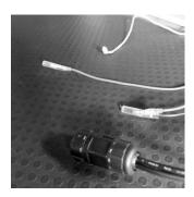
「照明用配線」と「ウォーターポンプ用配線」を運転席側キャビネットから助手席側キャビネットに渡しておきます。運転席側には「メインケーブル(電源)」と「アクセサリー電源線」を含めて 4 種類の配線が配置される事になります。キャビネットに接続する前に電源ケーブルには常時電源で DC12V(+)と(-)、アクセサリー電源はエンジンを始動させて初めて DC12V(+)が通電する事をテスター等で確認してください。(◆照明用配線はキャビネット上段から既に延長されている場合もございます)
