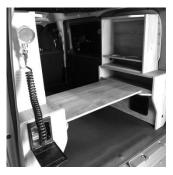
走行中およびテーブル板を使用しない時は付属の固定ボルトでキャビネット上部に設置固定します。(正しい位置に設置されていないと固定出来ません)キャビネット中段にてテーブル使用する際は「置くだけ」となります。(固定出来ませんのでご了承ください)
