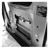
S700 系アトレー (ハイゼットカーゴ) の内張りを外します。(外す際はピンなどを破損させないように充分にご注意ください) リアシガーソケットが装着されているグレードは配線コネクターを抜いて絶縁処理してください。
