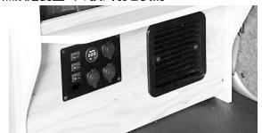
車中泊で重宝される設備の一つに「換気扇」がございますが、 車内に換気扇を設置するのは容易ではありません。本キット では運転席側キャビネットに無段階調整式の換気扇を標準 装備しております。弱風から強風まで自在に調整可能です。
