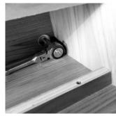
下段キャビネットの位置を正式に決めたらスパナ等の工具を使い付属のボルトで固定します。車両に密接させて手で押しても動かない位置で固定していきます。◆この時にボルトを締めすぎると車体が歪む恐れがございますので「適度」に締めてください
