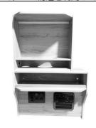
上段キャビネットを丁度良い位置に合わせたら付属のボルトナット(運転席側は鍋タイプ)で本固定します。ボルトにワッシャーを挟んで上から通し、下段キャビネット側にもワッシャーを挟みナットで押さえます。運転席側の上段キャビネットにはタケルくんとワクヨさんを設置するラックトレイを備えている為に横からスパナ工具等でボルトを回してください。ボルトナットがしっかりと固定されたら最後にエンドキャップ型のナット(怪我防止)を装着してください。以上で運転席側も設置完了となります。
