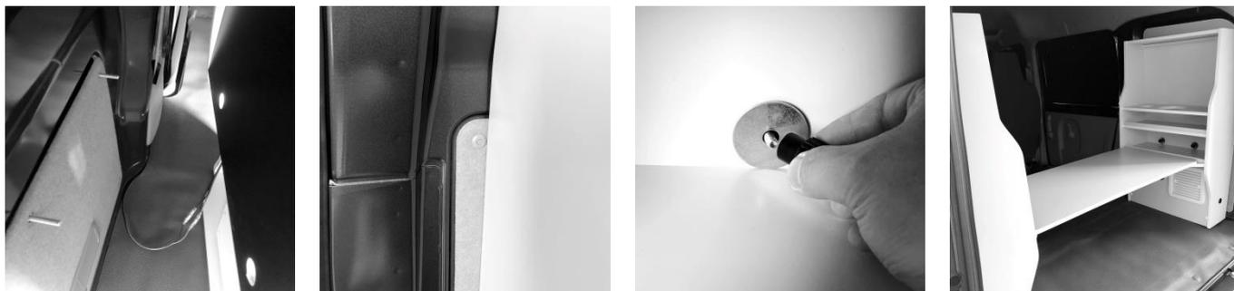
それぞれの配線を接続してから固定ボルトとキャビネットの穴を合わせて設置します。配線を挟まないようにして車両の壁面に沿って正しい位置を確認してください。円形プレートとナットキャップで固定します。（この時に前方向側のボルトを先に締めてください。） ※正しい位置に固定しないとテーブル板が設置できませんのでご注意ください。
