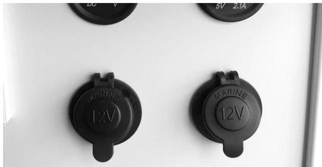
一般的に1台の車に10Aのシガーソケット出力を2か所設置する事は難しいとされております。本キットではエンジン始動時であれば運転席側キャビネットより2基のソケットを装備しております。（10A×2）
