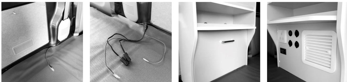
荷室フロアのマットを元に戻します。その際に助手席側にメインハーネスのLED照明配線、運転席側にメインハーネスのカプラ側配線とACC配線を出しておきます。キャビネットの助手席側は収納ボックス、運転席側は電装システムとなっております。
