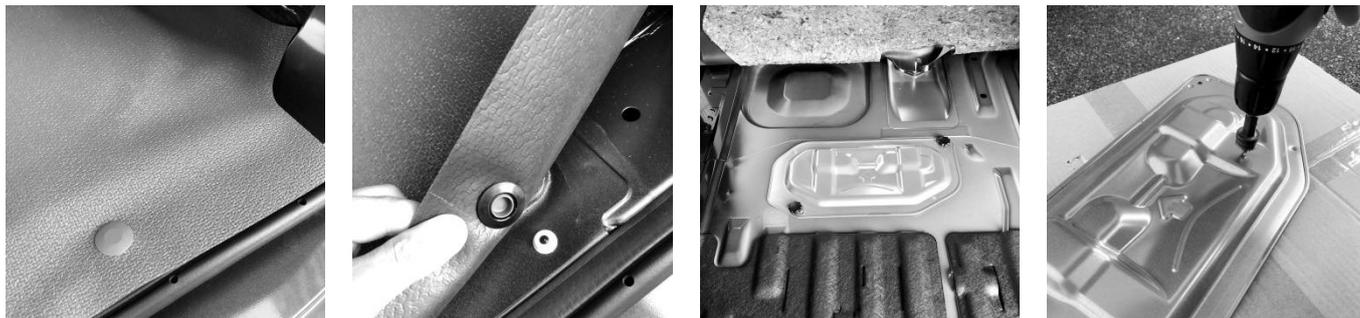
荷室フロアのマットを固定しているホックを外してバッテリーボックスを出します。2か所のツマミを回し上部パネルを外して付属のホールソー（22mm）を使って配線を通す穴を開けます。（電動工具等をご利用ください。）
