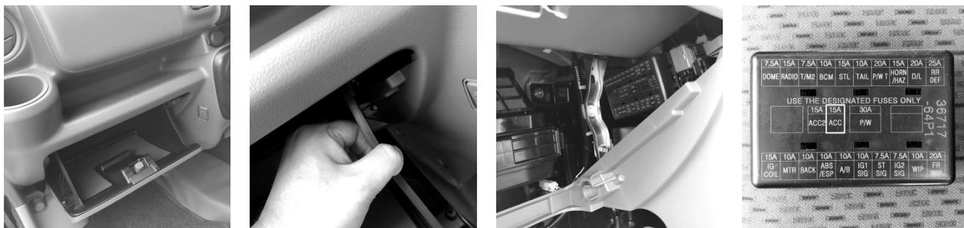
DA17V 型エブリイバンのヒューズボックスが助手席グローブ BOX 裏に設置されており、グローブ BOX を内側に絞りながら外すと右奥にヒューズボックスが出てきますので中央部の「ACC15A」から分岐して ACC 電源を取り出します。
